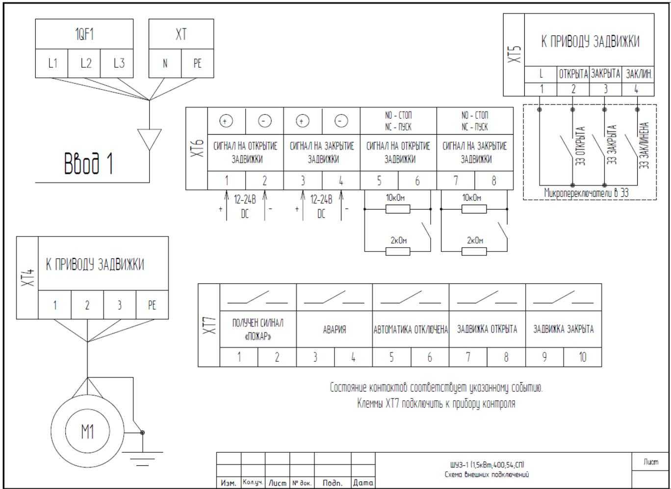
Схема внешних подключений для ШУЗ-2 (0,55/0,55кВт; 230/230; 54; СП)
