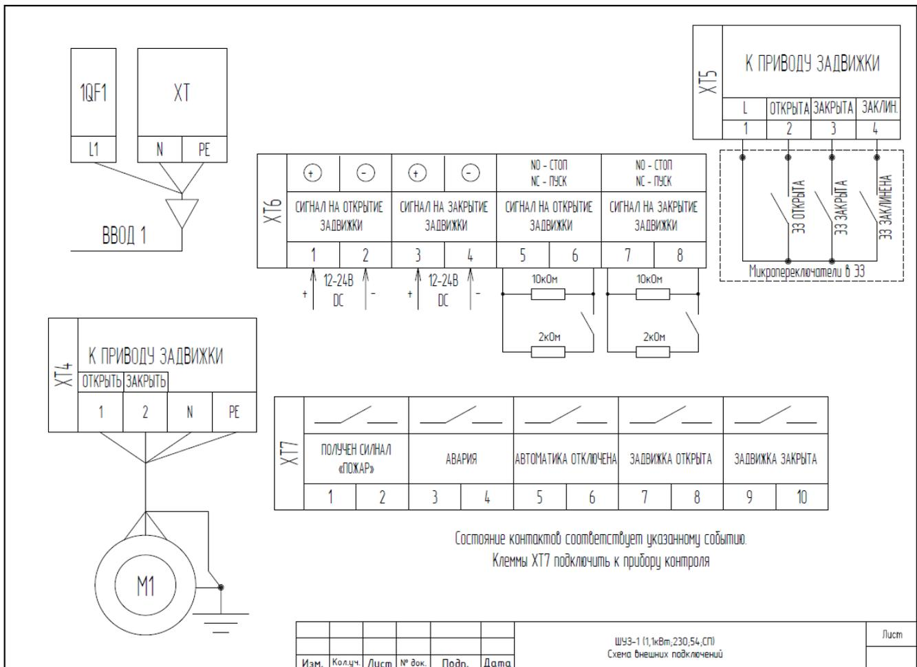
Схема внешних подключений для ШУЗ-1(1,5кВт; 400; 54; СП)
