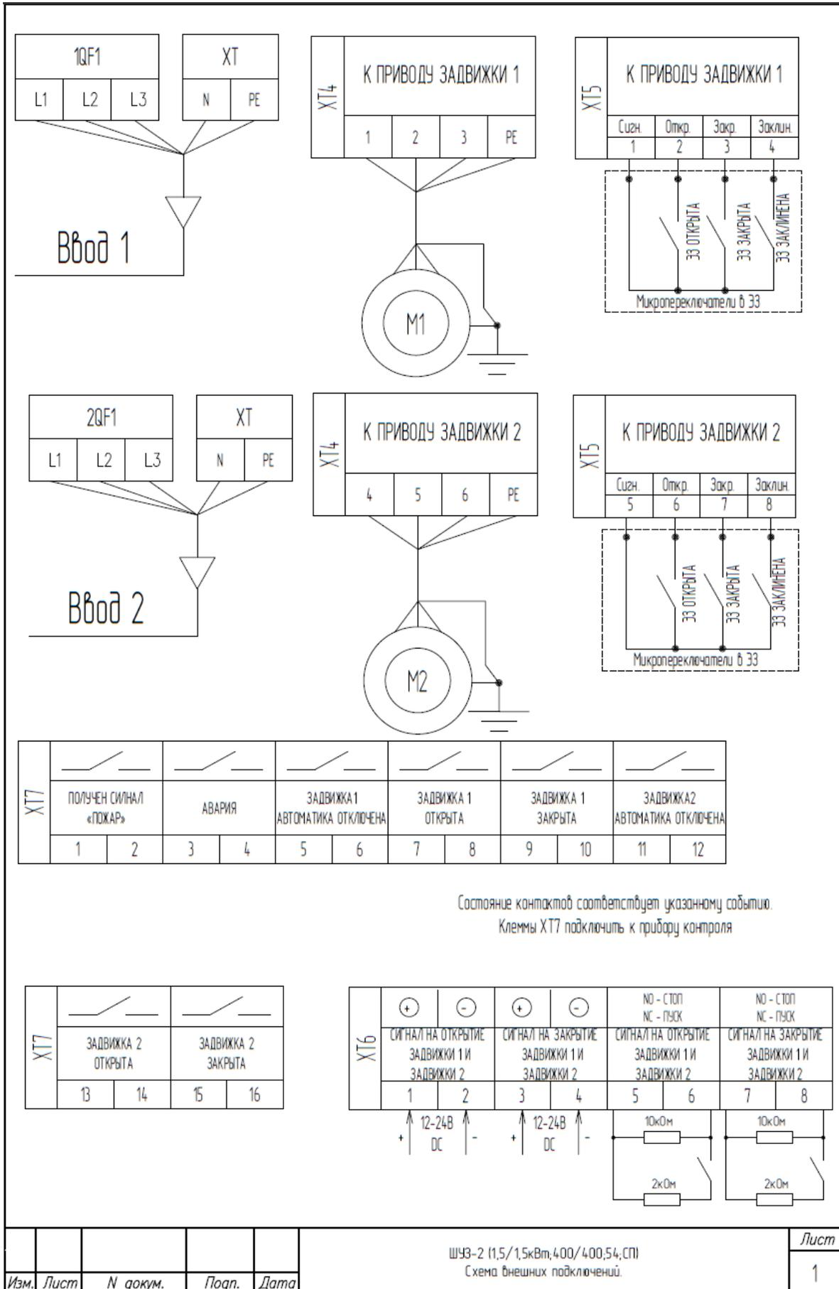
Схема внешних подключений для ШУЗ-2 (0,55/0,55кВт; 230/230; 54; СП/СП)
