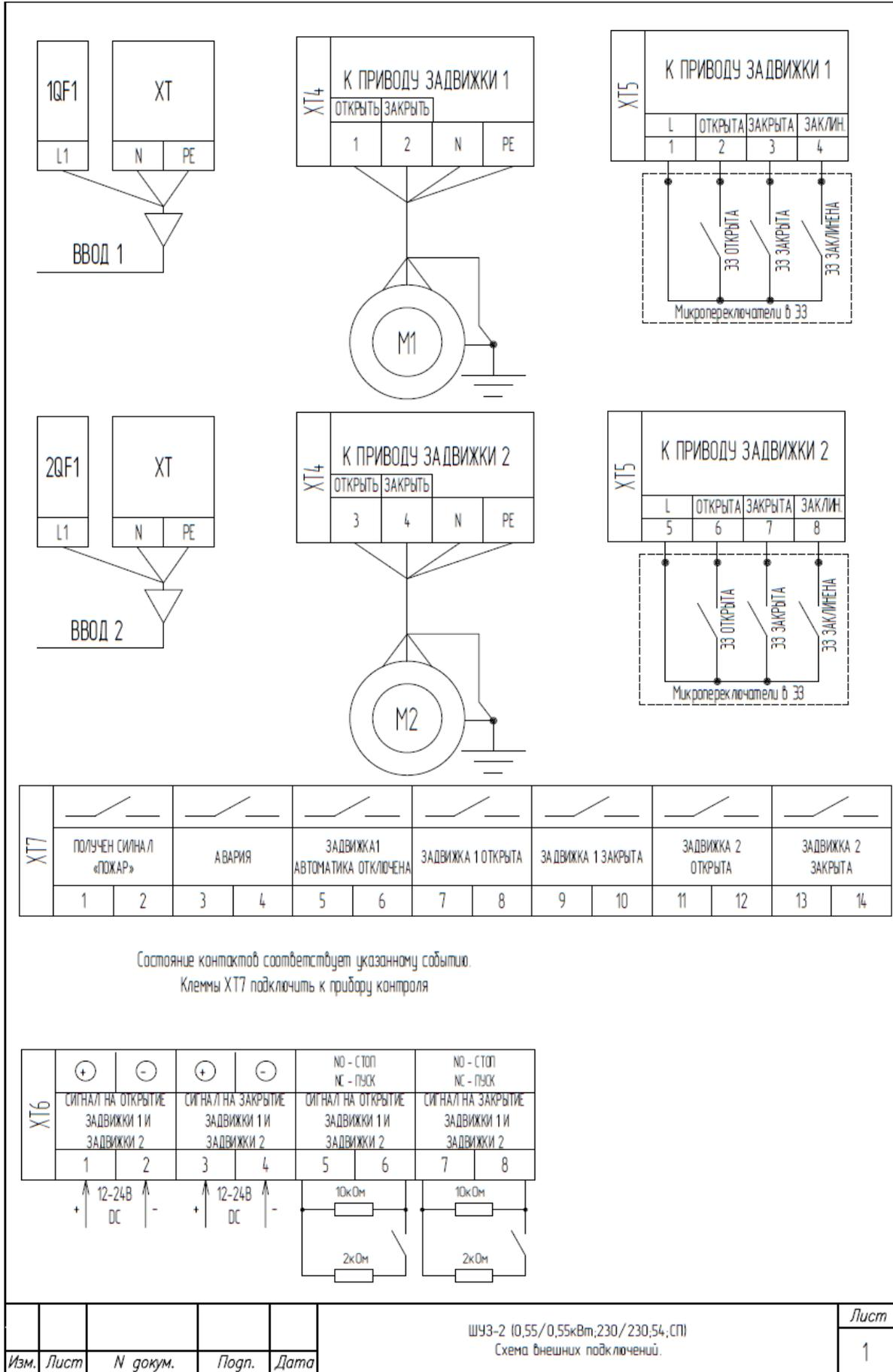
Схема внешних подключений для ШУЗ-2 (1,5/1,5кВт; 400/400; 54; СП)
