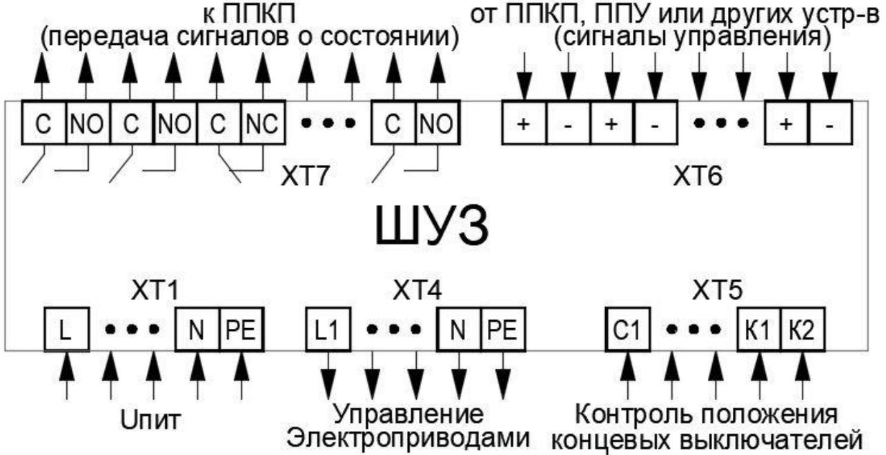
Схема внешних подключений для ШУЗ-1(1,1кВт; 230; 54; СП)
